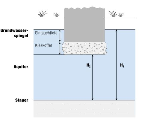
**Bedingung:**  $0.9 \cdot H_1 \cdot k_1 = H_2 \cdot k_1 + \text{Mächtigkeit Kieskoffer} \cdot \text{k-Wert Kieskoffer};$
