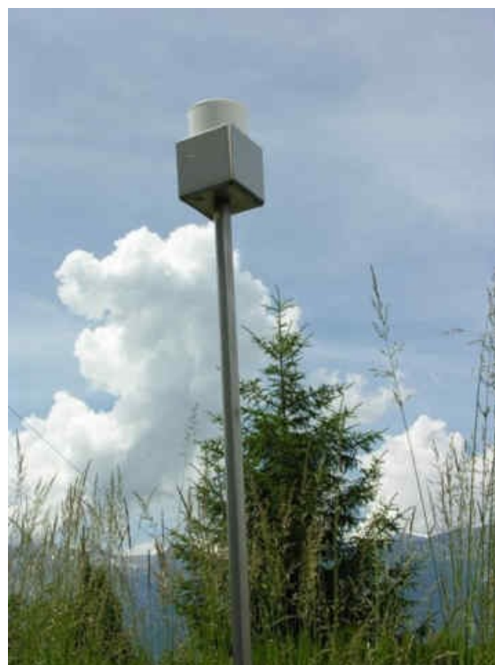
Bergerhoff-Gerät für die Staubniederschlagsmessung
