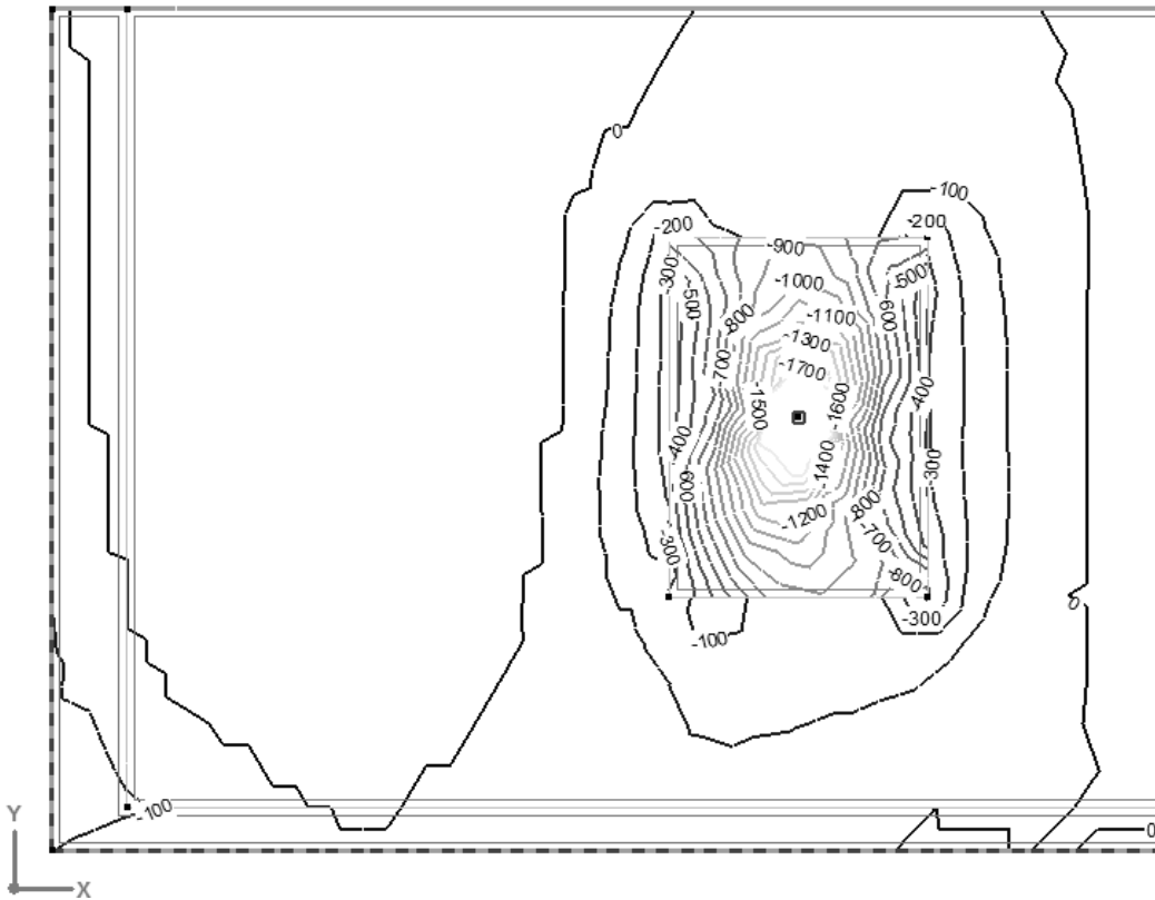
Moments de flexion pour armature inférieure en direction x
