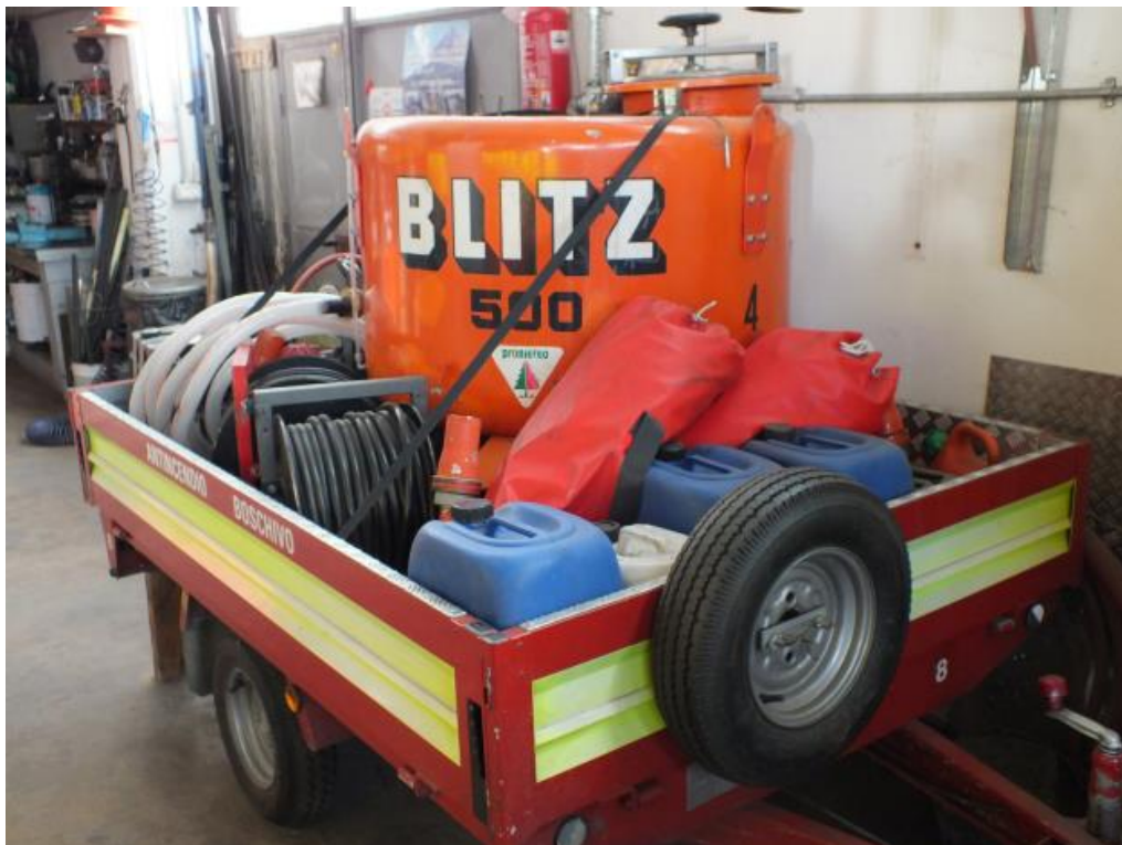
Bild 6: Mobiles Wasserreservoir mit Zubehör, das per Helikopter sofort ins Einsatzgebiet geflogen werden kann, Aostatal.
