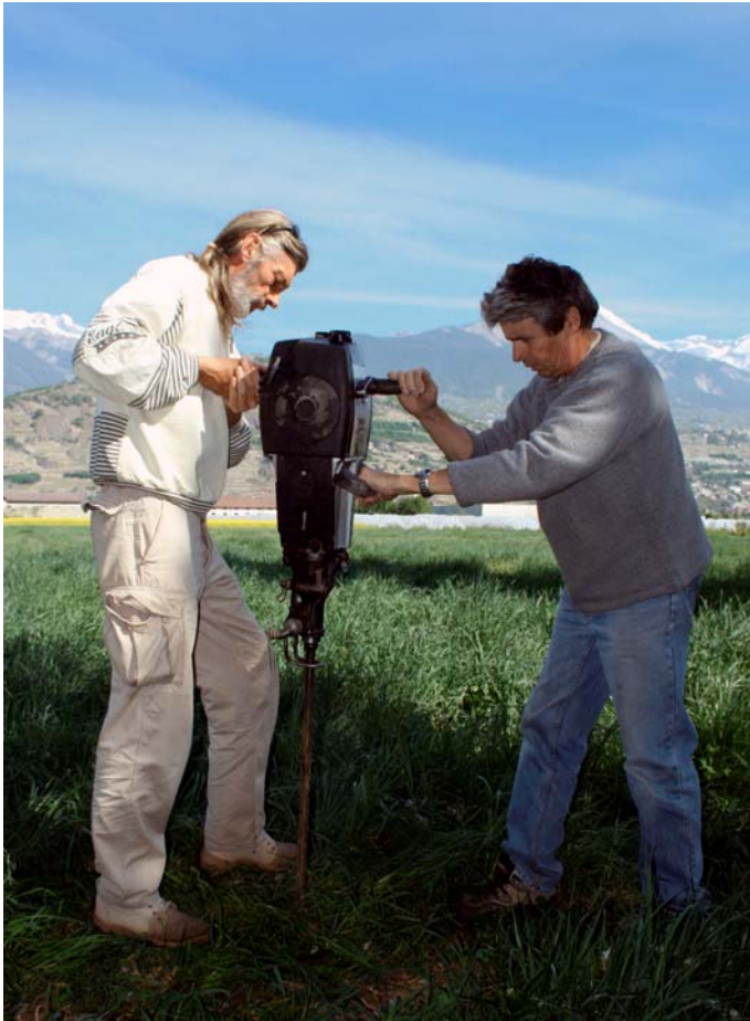
Figure 10 Percement des trous pour placer la charge explosive
