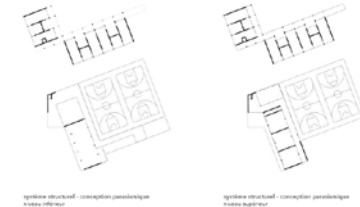
système structurel - conception parasismique noyau central
