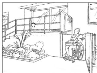
Plateforme élévatrice à déplacement oblique
