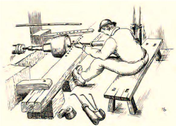
Fig. 26. Dessin illustrant un atelier de tournage de pierre ollaire avec l'ébauche placée sur un plan horizontal et l'artisan débitant l'intérieur de la roche. Tiré de DONATI et al. 1985, 34.
