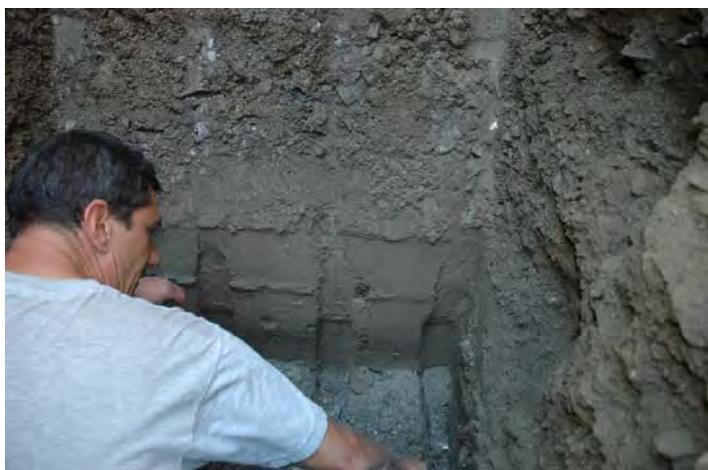
Figure 9 : Sondage 5. Apparition des niveaux limoneux à 6,6 m de profondeur, sous plus de 4 m d'alluvions.
