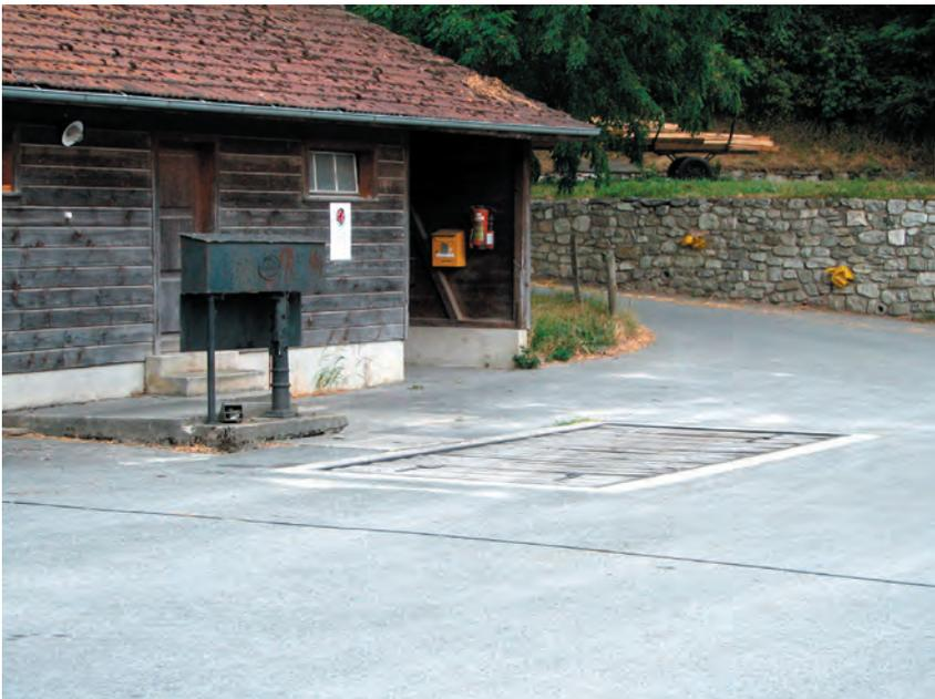
**Fig. 66** Ferme de Finges. Balance utilisée pour le pesage des récoltes ; le mécanisme est logé dans une caisse métallique solide. Le poids public de la rue des Remparts devait avoir une allure similaire.
