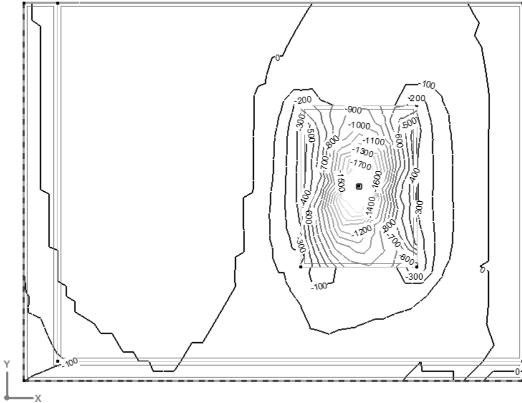
Biegemomente für untere Bewehrung in x-Richtung
