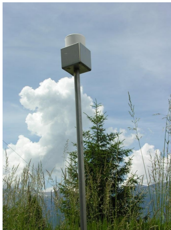
Abbildung 30: Bergerhoff-Gerät für die Staubniederschlagsmessung
