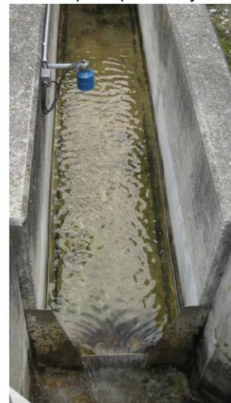
Figure 6 : Mesure de débit sur seuil en V
