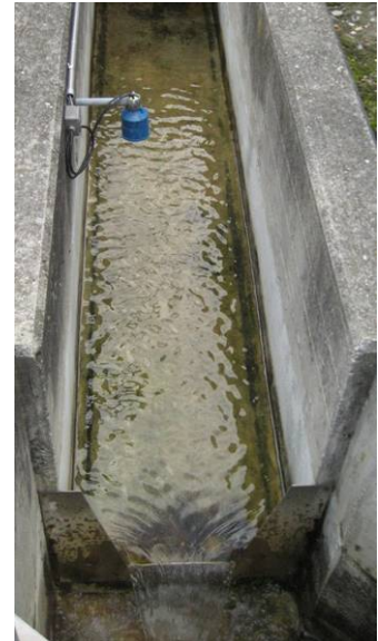
Abb. 6 : Durchflussmessung bei Dreiecküberfall
