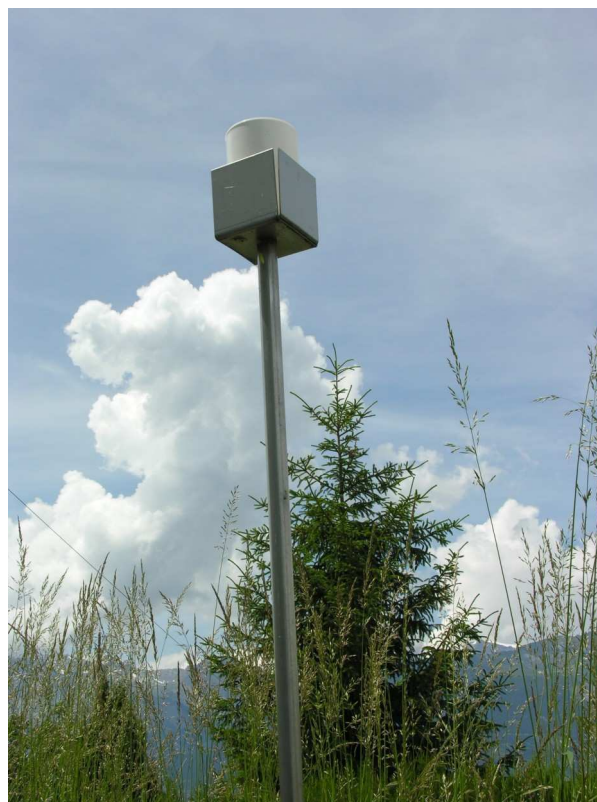
Abbildung 30: Bergerhoff-Gerät für die Staubniederschlagsmessung
