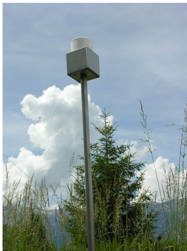
Figure 30 : Appareil de prélèvement Bergerhoff
