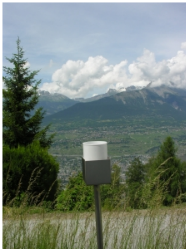
Abbildung 10: Bergerhoff-Gerät für die Staubniederschlagsmessung
