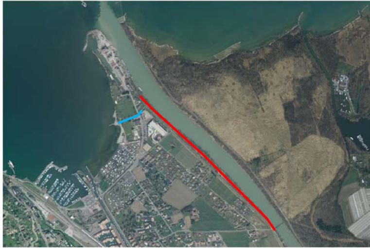
**La vue aérienne ci-dessus présente le secteur d'intervention de la mesure anticipée de Port-Valais, avec le renforcement de digue (en rouge) et la mise à ciel ouvert du canal de la Benna (en bleu).**
